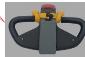
El interruptor de llave y el medidor de electricidad están integrados en el mango
