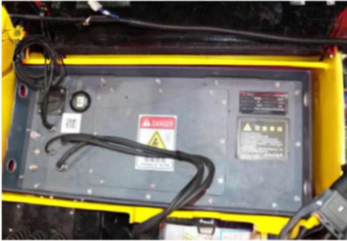
Batería LEF Li-ion con sistema BMS
