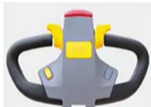
Cabezal timón FREI con botón de elevación lateral (Opcional)
